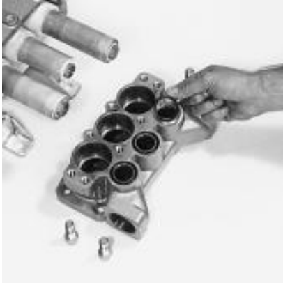
Retrait des joints toriques du collecteur d'aspiration
