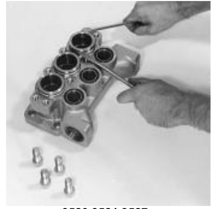
3520, 3521, 3527 Retrait du cylindre garniture-V
