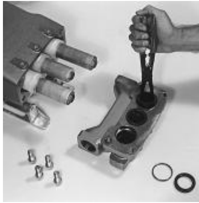
Retrait du joint basse pression du collecteur d'aspiration.
