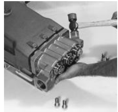
Retrait des vis et du collecteur d'aspiration.
