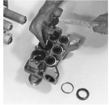
3531, 3535, 3537, 3541, 3545 Joint basse pression et ensemble de rondelles.
