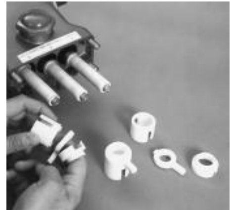
Enlèvement des boîtiers de joints
