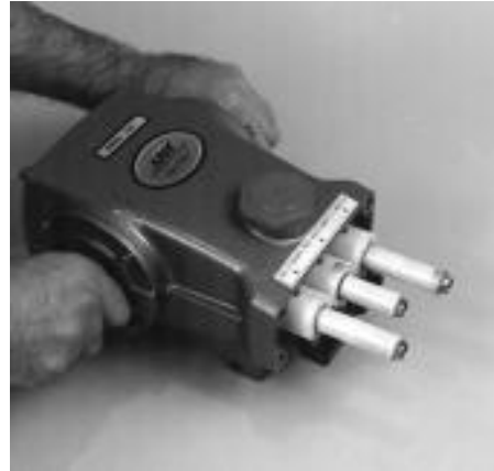
Un bon alignement des plongeurs céramiques pour le remontage.
