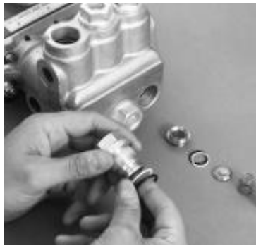
Examen du joint torique et de la bague anti-extrusion du bouchon de clapet.
