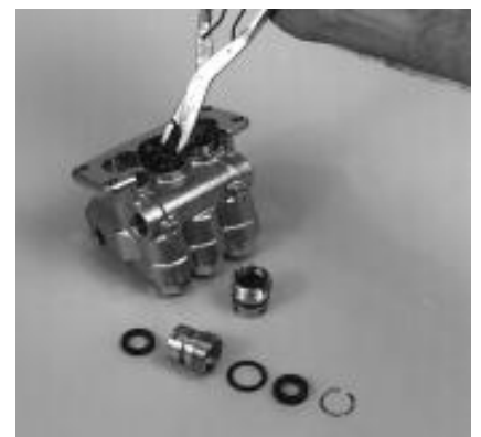
L'enlèvement des joints haute pression
