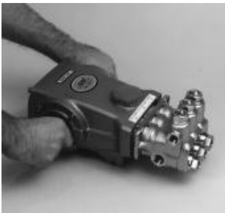
Séparation de la tête du collecteur
