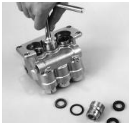
L'enlèvement des boîtiers de joints de la tête du collecteur
