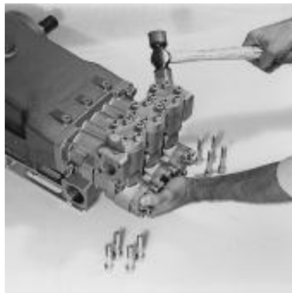
Retrait du collecteur de décharge.
