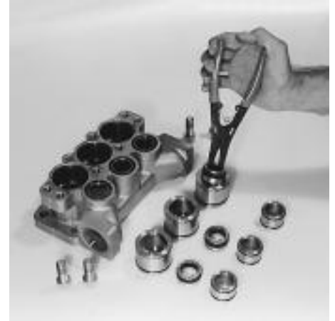
Retrait de l'adaptateur mâle, la garniture-V et l'adaptateur femelle.
