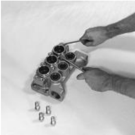
Retrait du cylindre (garniture-V).
