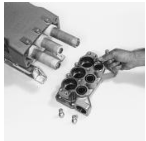
Retrait du joint torique du collecteur d'aspiration.
