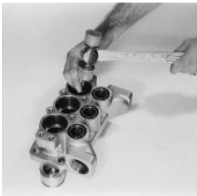
Retrait de l'adaptateur d'aspiration du collecteur d'aspiration
