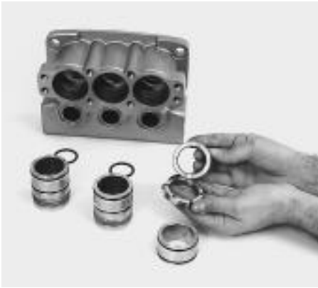
Faire correspondre l'entretoise avec ressorts hélicoïdaux et les garnitures.
