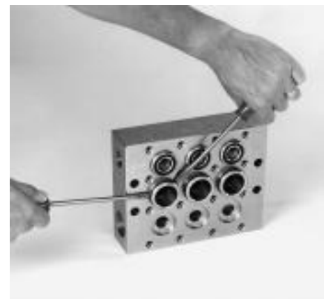
2831 Retrait de l'entretoise haute pression du collecteur d'aspiration & décharge.
