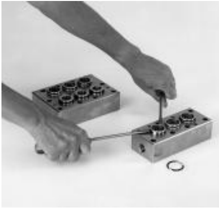
Retrait de l'ensemble du clapet de décharge du collecteur de décharge.
