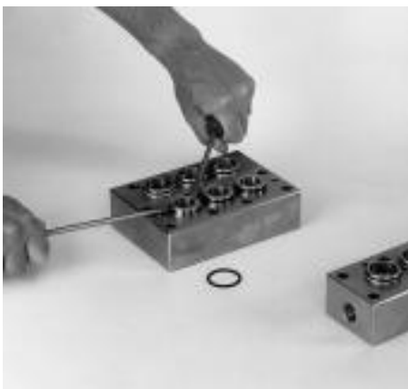
Retrait du cylindre garniture-V ou de l'adaptateur femelle du collecteur bloc usiné de clapet.
