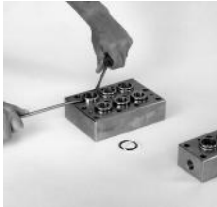
Retrait de l'ensemble du clapet d'aspiration du collecteur bloc usiné.
