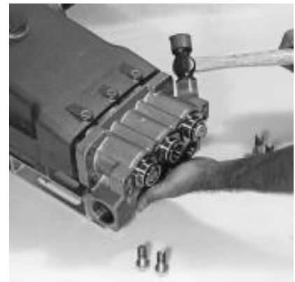
Retrait des vis et du collecteur d'aspiration.
