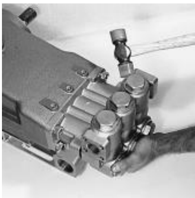
Tous les modèles, sauf la 3560 Retrait du collecteur de décharge.
