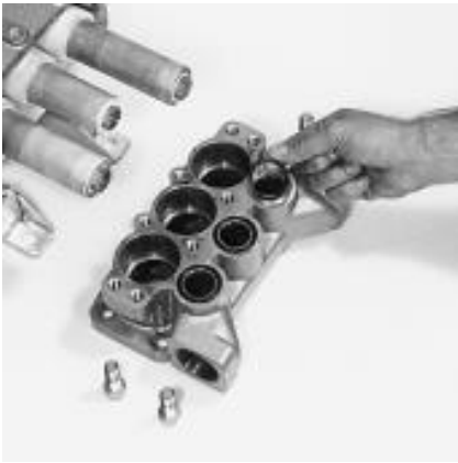
Retrait des joints toriques du collecteur d'aspiration
