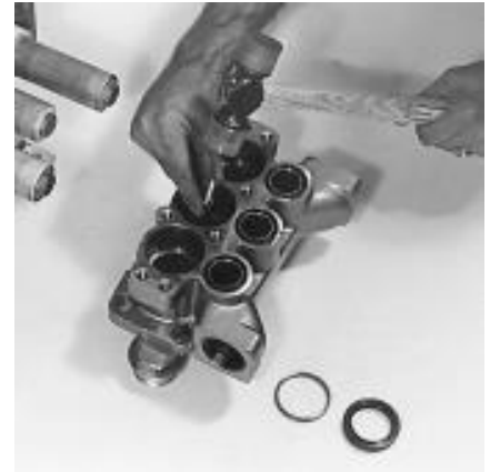
3531, 3535, 3537, 3541, 3545 Joint basse pression et ensemble de rondelles.
