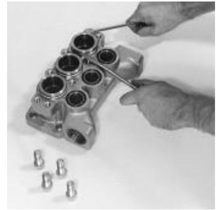
3520, 3521, 3527 Retrait du cylindre garniture-V
