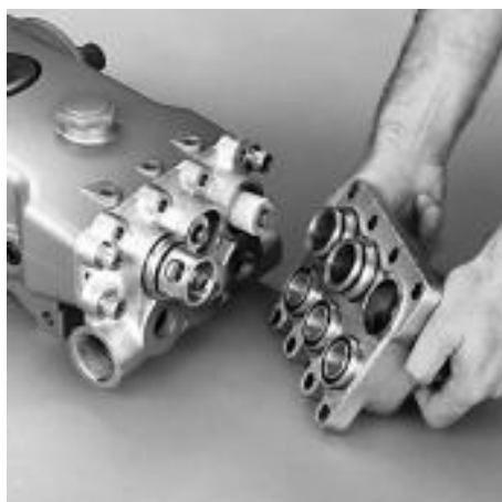
Retrait des entretoises des clapets de décharge
