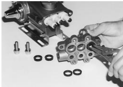
Retrait des joints haute et basse pression.
