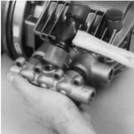
Retrait du collecteur de décharge.
