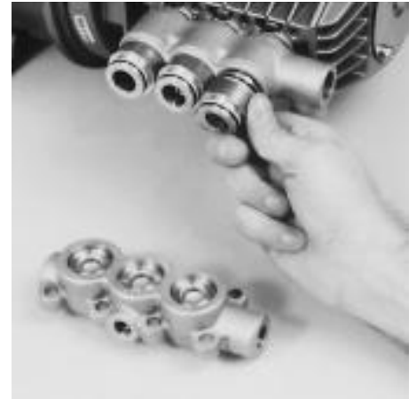
Retrait de l'adaptateur du collecteur d'aspiration.
