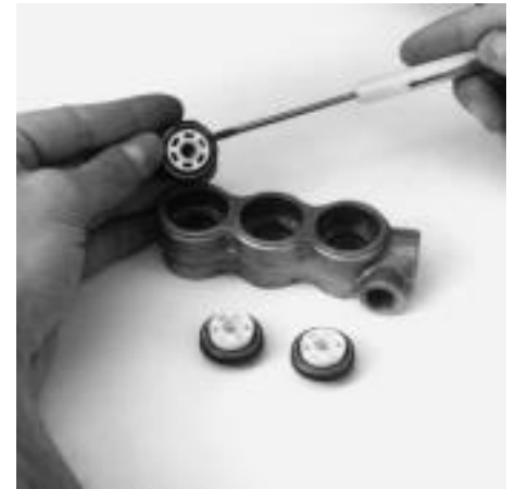
Installation des garnitures-V.
