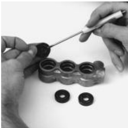
Installation des joints basse pression.
